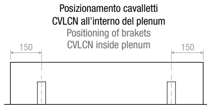
Vista laterale posizione CVLCN lunghezza sino 1500 mm Side view position CVLCN length to 1500 mm
